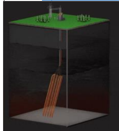
Фиг. 5. Eavor-Lite™ и Eavor-Loop™2.0 версии на кондуктивна геотермална електроцентрала (източник: https://www.eavor.com/ )
