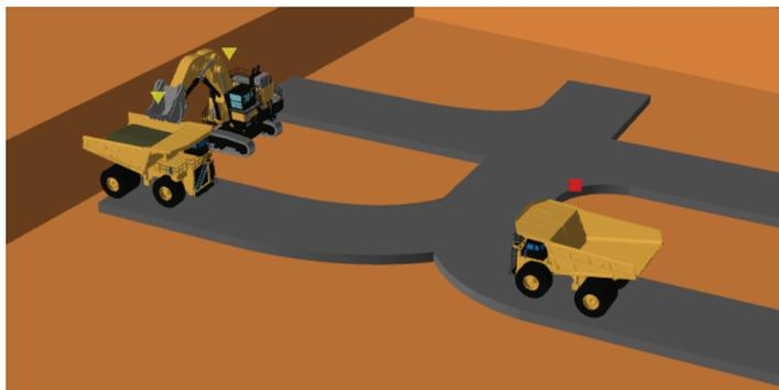
Фиг. 3. Работа на хидравличен багер при полукръгова схема на подаване на автосамосвалите (изглед от софтуерния продукт HAULSIM)
