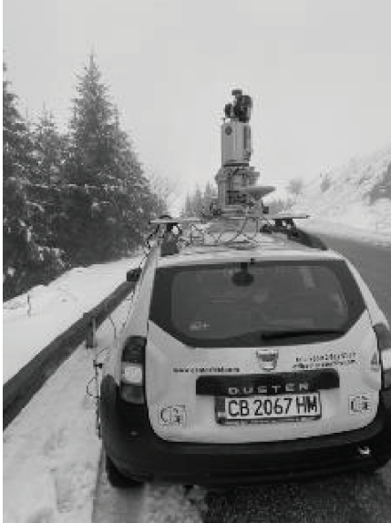
Фиг. 1. (1) Интегрирана лазерна станция "Riegl-VZ-2000, монтирана на превозно средство; (2) изглед отблизо на сканиращата система
