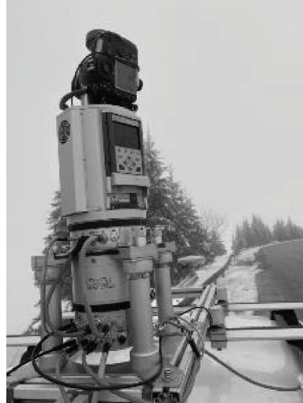
Фиг. 1. (1) Интегрирана лазерна станция "Riegl-VZ-2000, монтирана на превозно средство; (2) изглед отблизо на сканиращата система
