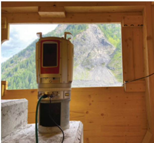
Фигура 10. Монтаж на системата RIEGL VZ-2000i във Валс. Стълб и заслон.
