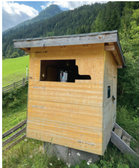
Фигура 10. Монтаж на системата RIEGL VZ-2000i във Валс. Стълб и заслон.
