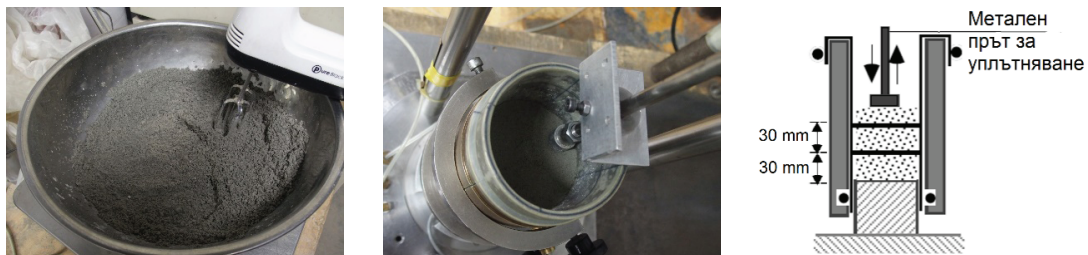
Фигура 4. Подготовка на образците по метод „ мокро трамбоване“
