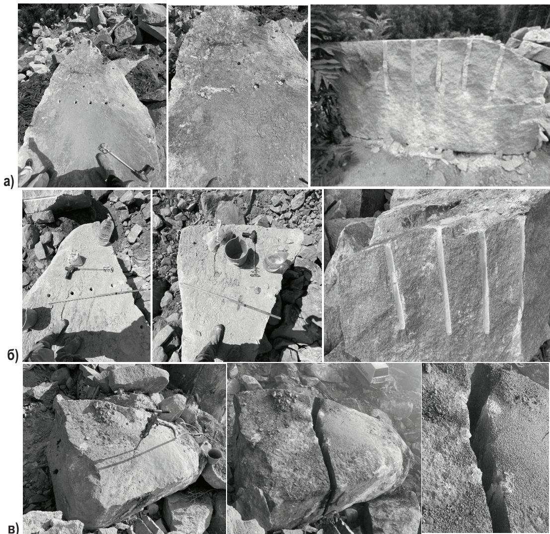
Фиг. 4. Разцепване на скален блок чрез експандиращи химични смеси на кариера „Казаните 1“; а) Тест 1; б) Тест 2; в) Тест 3
