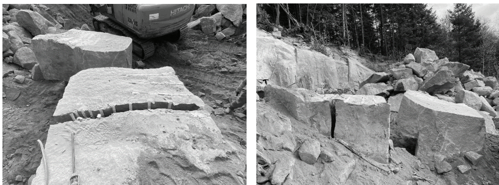
Фиг. 3. Добив на риолит чрез експандиращи смеси
