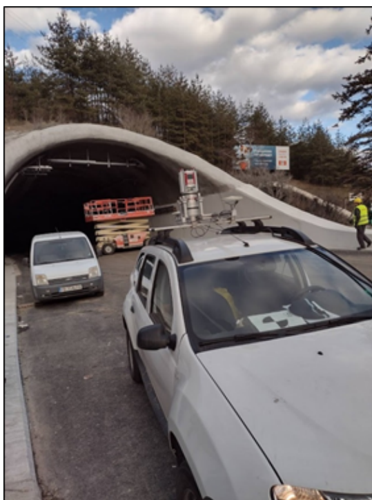
Фиг.3: Инерциалната система MTLN RIEGL VMZ 2000 – монтирана върху автомобил
