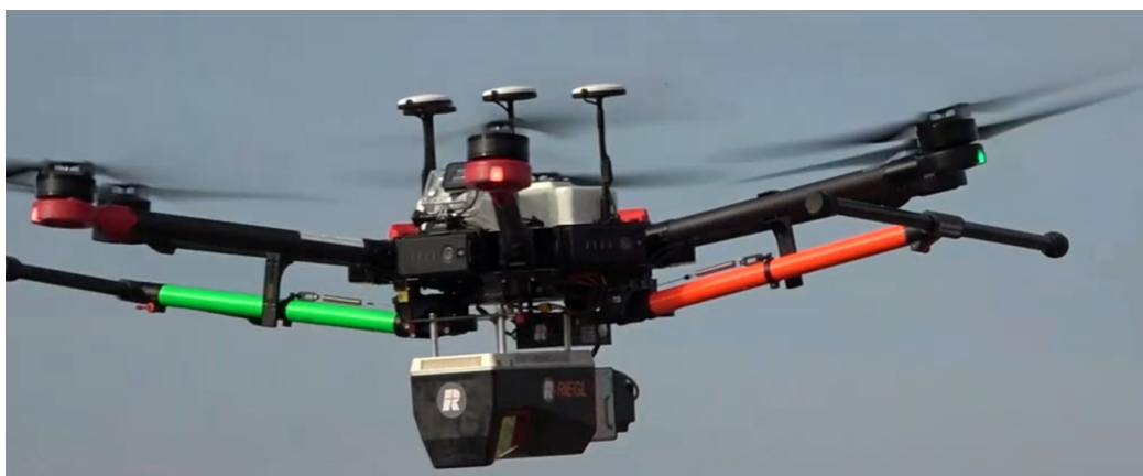
18.) RIEGL VUX-120 „NFB“ в полет на борда на DJI 600 Pro БЛА
