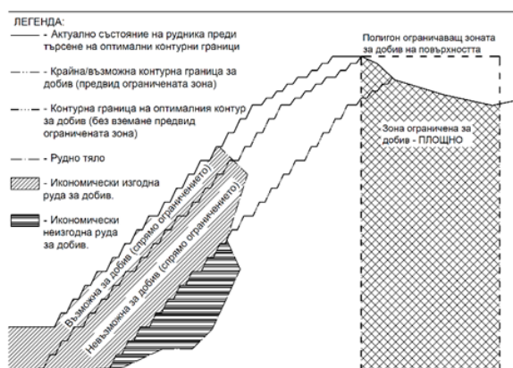
Фиг. 2. Примерен профил, показващ логическата работа на софтуера при площно ограничаване на зоните за добив
