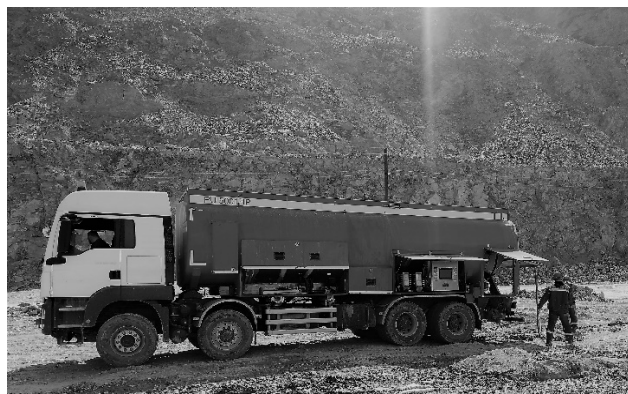
Фиг.4. Проектиране на непрекъсната конструкция на заряд от ВВ с използването на „Paradigm“ и сондажно-заряден тежкотоварен автомобил, „Licensed by Austin Powder“
