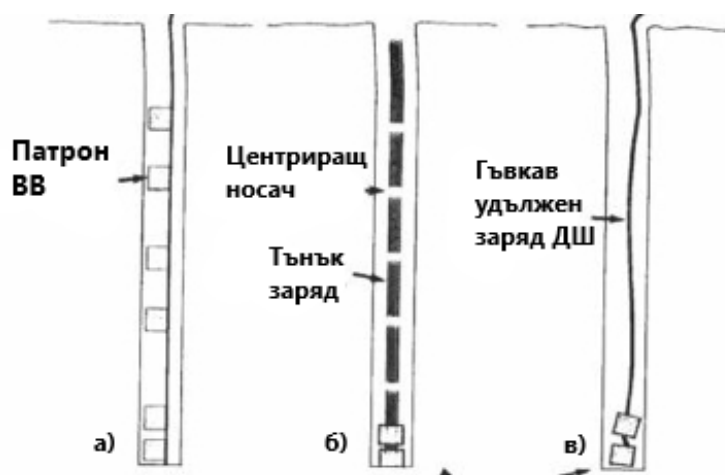
Фиг. 4. Взривни дупки за провеждане на деликатно взривяване а.) с разсредоточени заряди от бризантно ВВ, свързани с ДШ и без забивка; б.) с разсредоточени заряди от бризантен експлозив с чувствително намален диаметър, разположени в средата по оста на отвора, свързани с ДШ и без забивка; в.) с нишка от ДШ и дънен заряд от бризантен експлозив без забивка.
