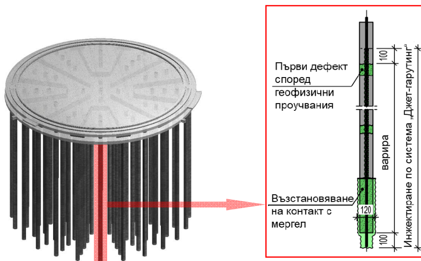
Фиг. 13 Концепция за усилване на дефектни пилоти чрез система „джет-граутинг“ – фундаментна конструкция на резервоар за амоняк в град Девня
