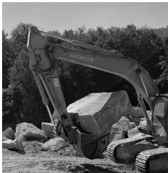
Фиг. 4. Добив на риолитни блокове чрез багер
