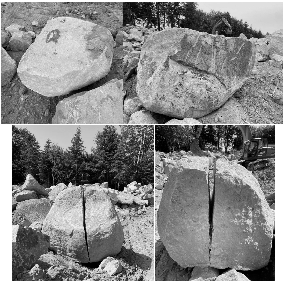
Фиг.5. Разцепване на скален блок чрез експандиращи химични смеси на кариера „Казаните 1“
