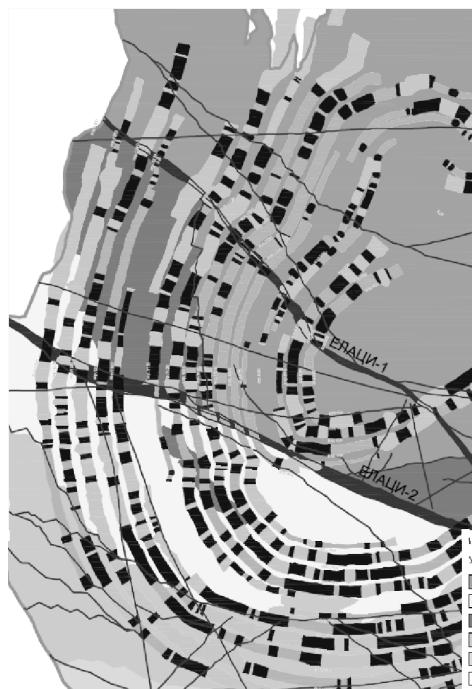
Фиг. 11. Западната и южната част от рудничния котлован е постигнат проектен ъгъл от 65^\circ .
