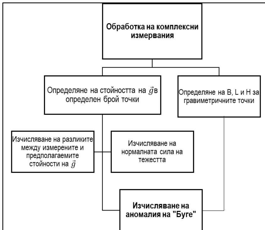
Фигура № 6. Схематично представяне на плана за обработка на данните от измерванията
