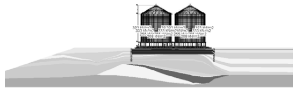
Фигура 3: Надлъжен и Напречен инженерно-геоложки разрез. Натоварвания при основна комбинация от натоварвания (Изчислителни товари)
