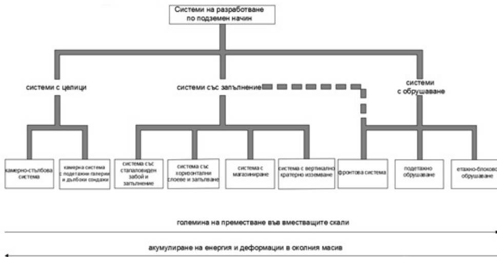
Фиг.1 Връзка между напреженията и деформациите в зависимост от прилаганата система при подземно разработване
